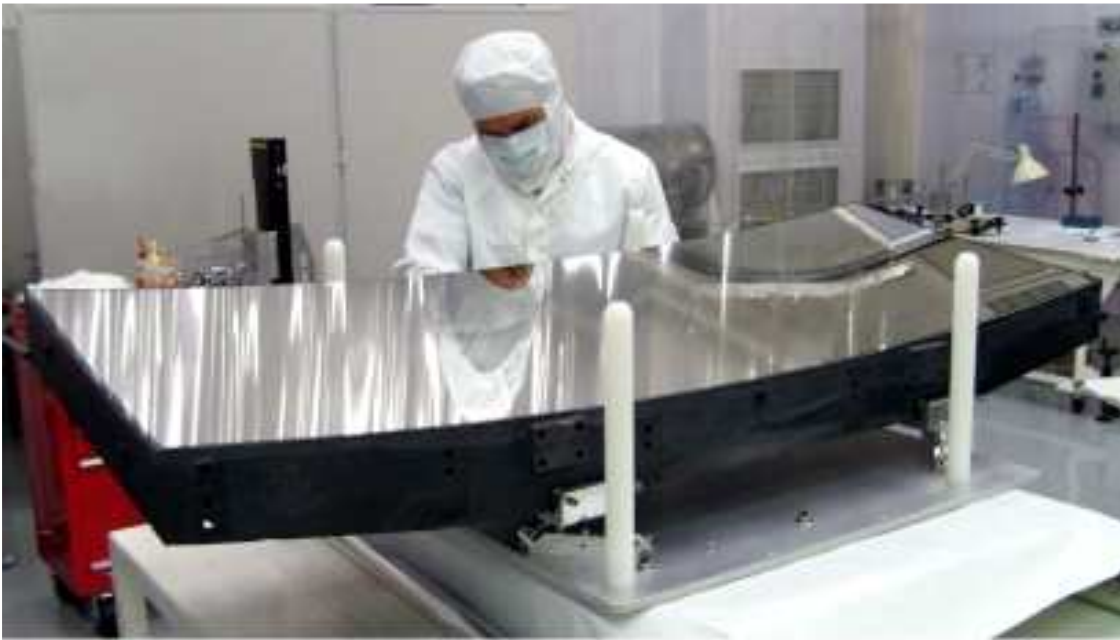
Fig 3: Un des miroirs primaires de Gaia (Copyright: Image courtesy of Sagem, France)
