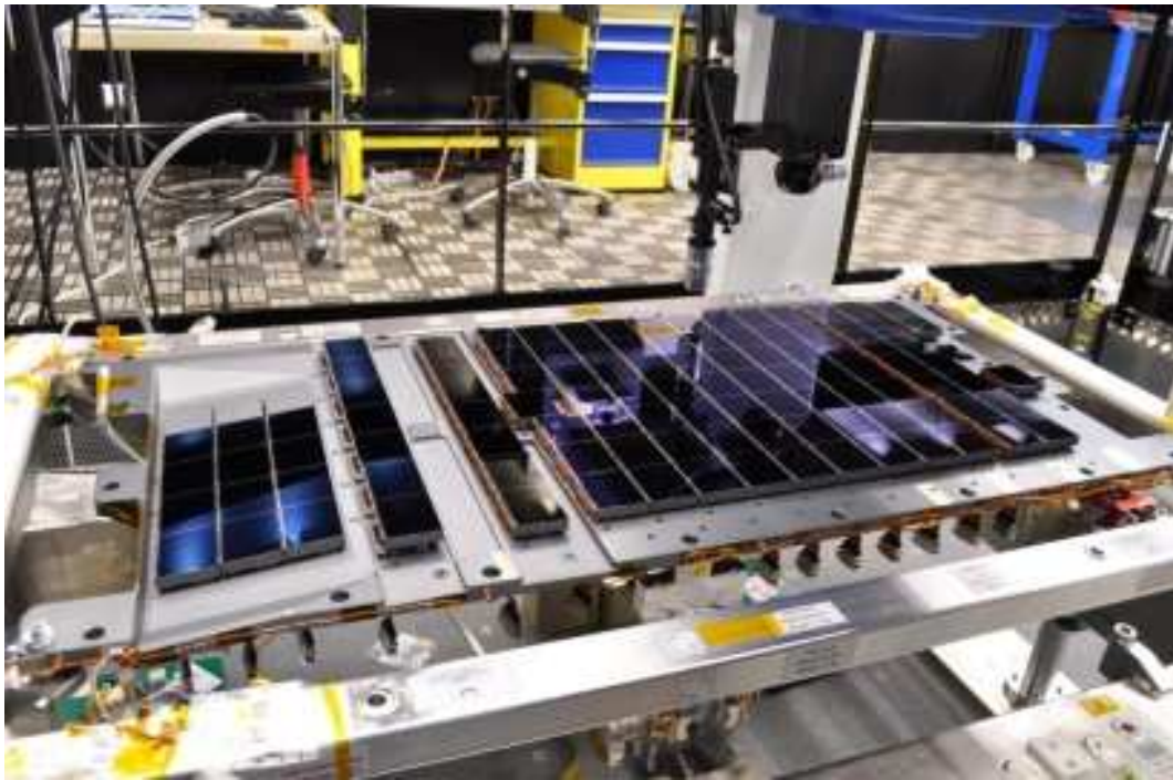
Fig. 4 : La mosaïque complète de CCD de Gaia (Copyright: Astrium)
