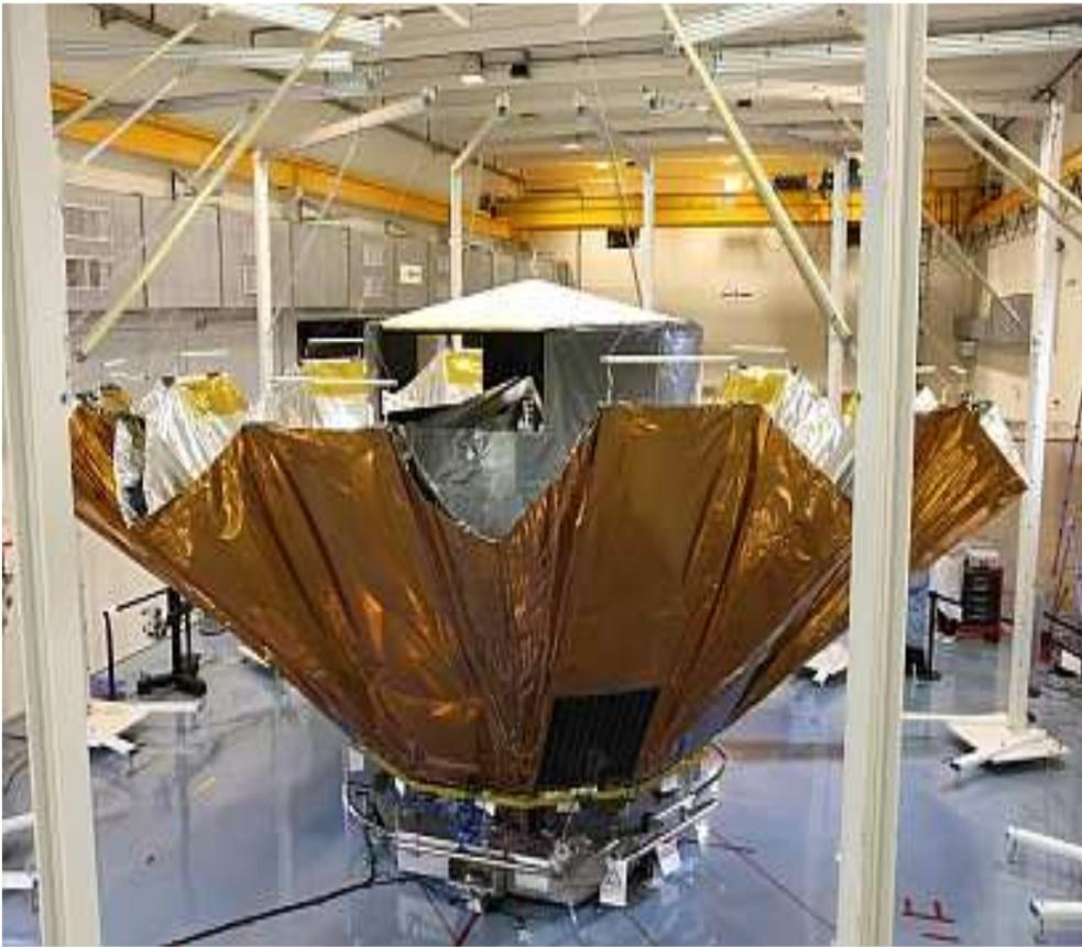
Fig. 1 : Le satellite Gaia, pendant le déploiement de sa protection solaire (Copyright: Astrium France).
