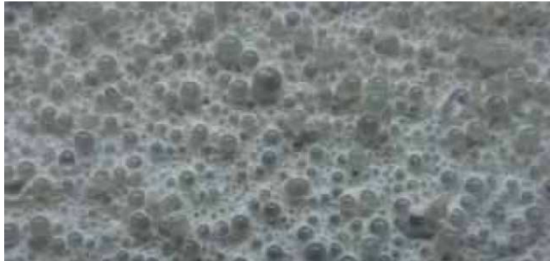
Marquage plan "classique" saupoudré de grandes microbilles de verre. Légende: © Sovitec
