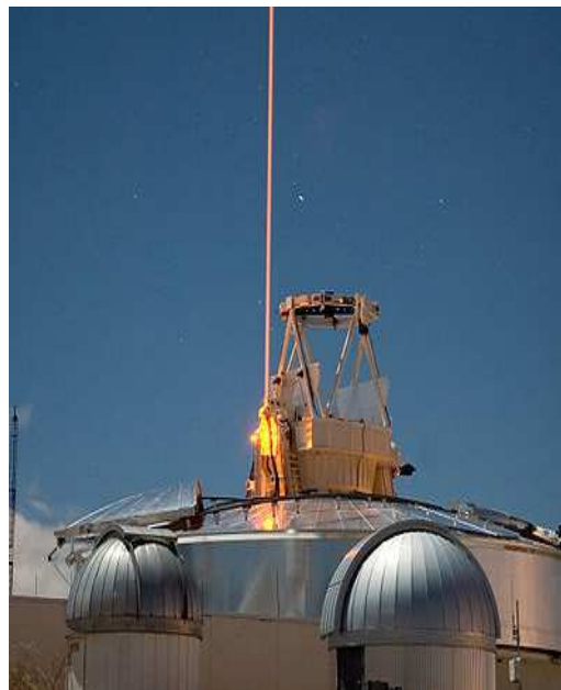
Figure 22 - LIDAR expérimental utilisé pour exciter les atomes de sodium dans la haute atmosphère.
