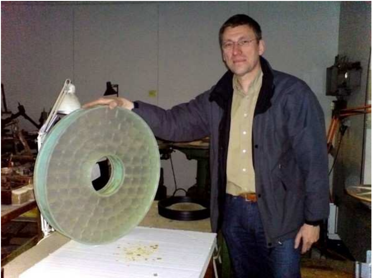
Le miroir du T600 ULISSE, lors du polissage chez Lichtenknecker Optics
