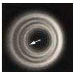
Pointer et centrer dans le champ une étoile de magnitude 2 à 3 suffisamment haut au-dessus de l'horizon pour limiter la turbulence atmosphérique. Adapter un oculaire pour atteindre un grossissement valant 2 à 3x le diamètre du tube en mm. Jouer avec la mise au point pour défocaliser légèrement et observer le système d'anneaux concentriques qui se dévoile en intrafocal et extrafocal. Les anneaux doivent être symétriques et concentriques autour du point lumineux central.
